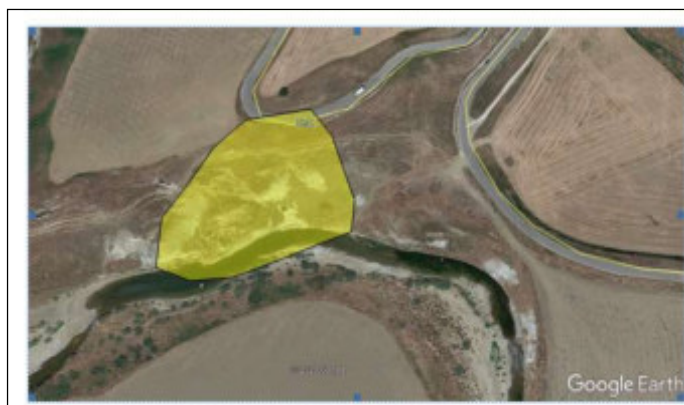
Foto aerea dell'area della SP 38 interessata da una frana complessa causata dall'erosione regressiva del F. Salito
