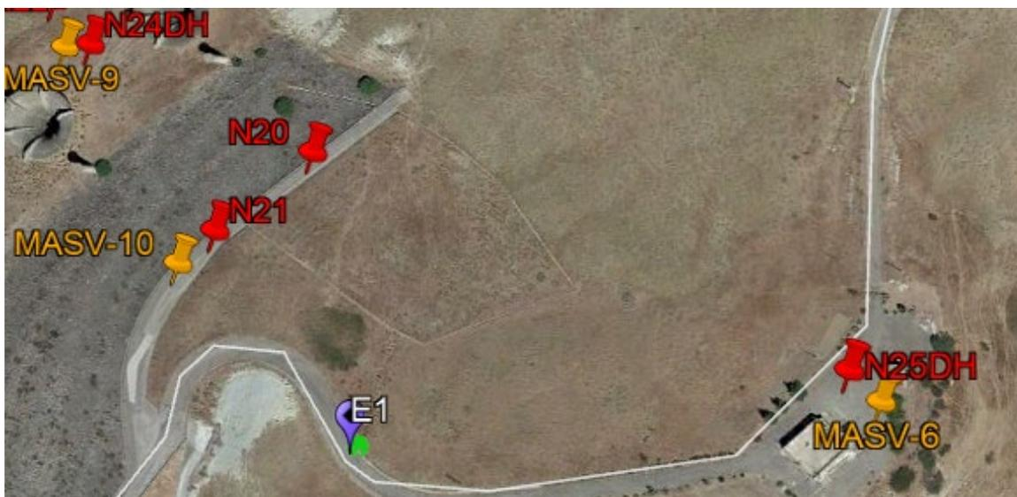
Nell'area del **canale di restituzione** saranno eseguiti un sondaggio (N26) lungo 10 m con prelievo di un campione indisturbato ed uno stendimento MASW (MASV-12). L'ubicazione delle indagini è riportata nell'immagine che segue.
