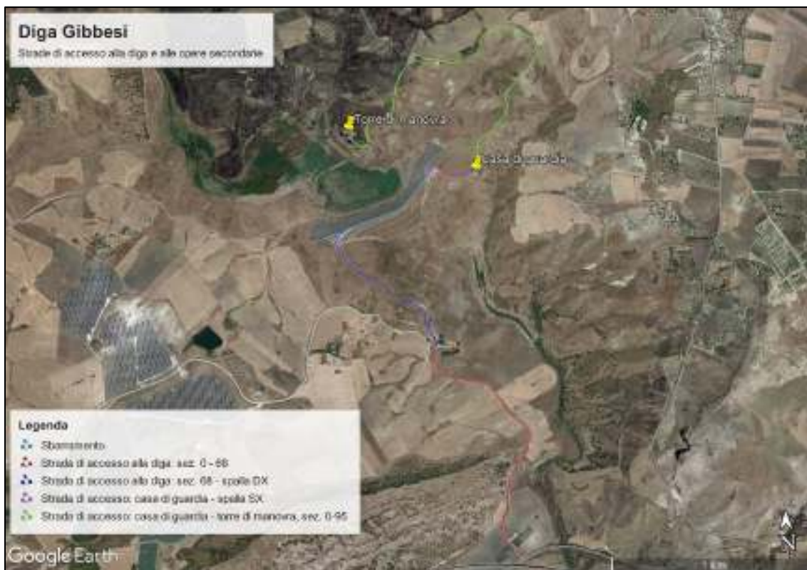
Figura 3-33: Disposizione delle strade di accesso alla diga e alle sue opere accessorie
