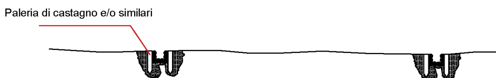
Figura 3. Rappresentazione tipo di "Tagliata stradale" su pista forestale utile al migliore deflusso delle acque meteoriche
