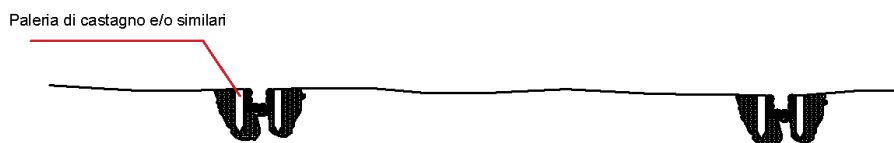
Figura 9 – Rappresentazione tipo di “Tagliata stradale” su pista forestale utile al migliore deflusso delle acque meteoriche
