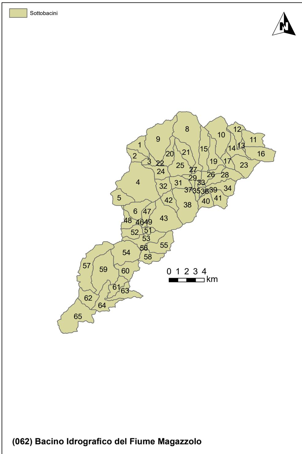
Figura 6 Delimitazione dei sottobacini sulla base delle caratteristiche morfologiche e della densità di drenaggio
