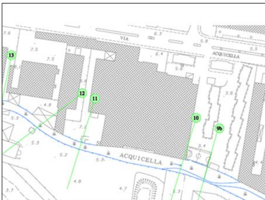
Fig.5 – Stralcio cartografico con ubicazione di alcune sezioni utilizzati per la verifica idraulica
