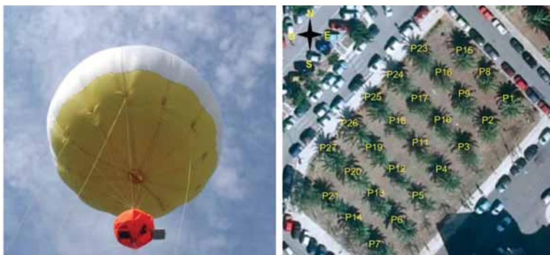
Fig.1 – Pallone aerostatico frenato ad elio con camera termica (Flir SC660) a bordo (pannello di sinistra), area di studio (pannello di destra) con relativa numerazione delle palme (da P1 a P27).
