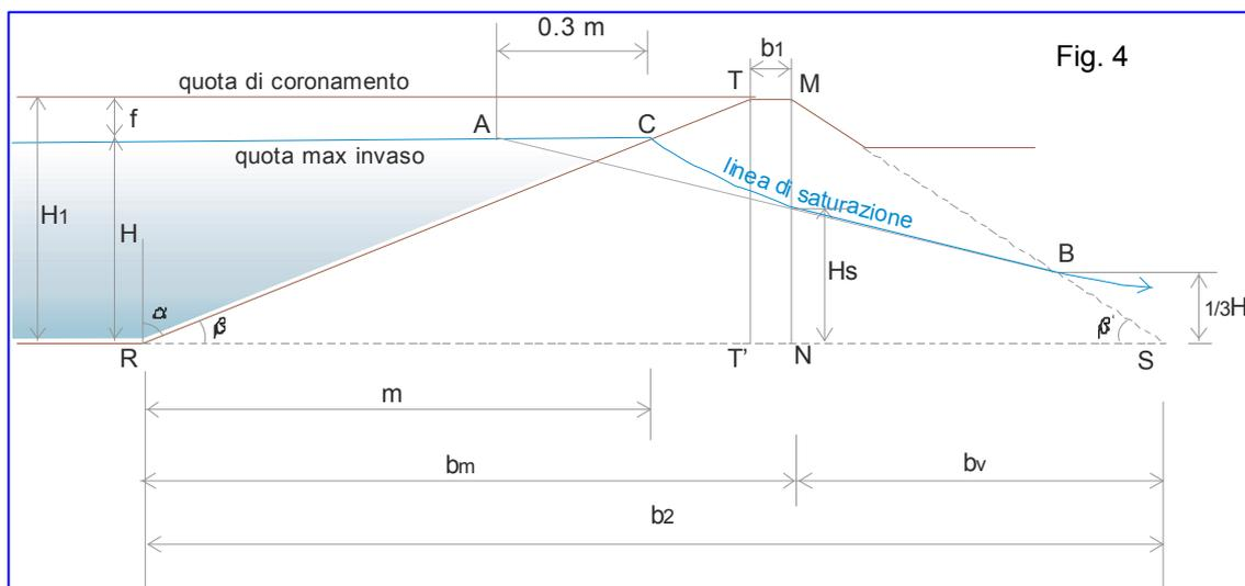
In tutti i punti al di sotto di tale linea il materiale è saturo d'acqua e quindi soggetto alla pressione idrostatica, mentre al di sopra della linea, la pressione manca.
