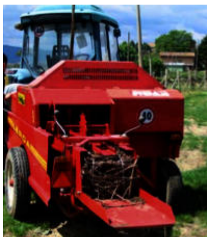
Figura 13 Imballatrice parallelepipedica LERDA 900 e Rotoimballatrice leggera ARBOR RS170.
