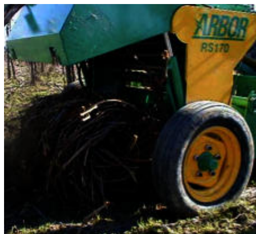
Figura 13 Imballatrice parallelepipedica LERDA 900 e Rotoimballatrice leggera ARBOR RS170.
